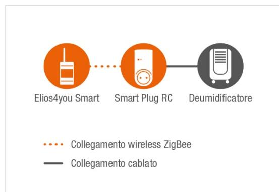
Fig. 1: Schema di collegamento Elios4you Smart, Smart Plug RC e deumidificatore
